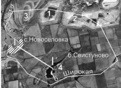
Рис. 1. Границы моделируемой области (М 1:100000): 1, 2 – хвостохранилища ЮГОКа „Войково“ и „Объединенное“, 3 – отвалы „Левобережные“, 4 – пруд-накопитель шахтных вод в балке Свистуново
