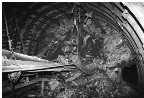
Рис. 3. Обрушение пород кровли в вентиляционной выработке
